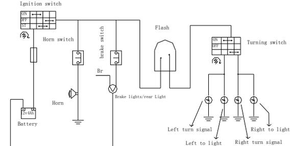
电器原理图 (分解)
